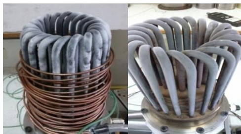
شکل ۱۲. خروجی تولید سرمایش با استفاده از موتور استرلینگ گاما از نوع ST500
