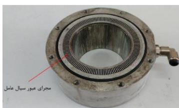
شکل ۸. خنک کن موتور استرلینگ و مجرای عبور سیال
