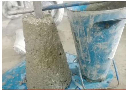
شکل ۴. آزمایش تعیین روانی به روش اسلامپ
