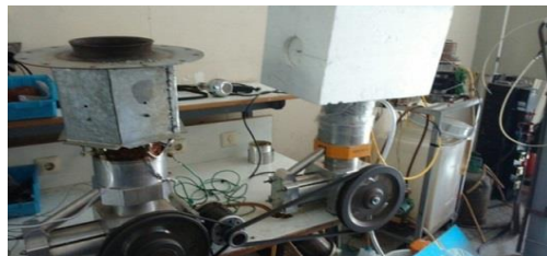
شکل ۲۲. نمای واقعی کوپلینگ موتور استرلینگ ST500 (گرم و سرد) برای تولید سرمایش
