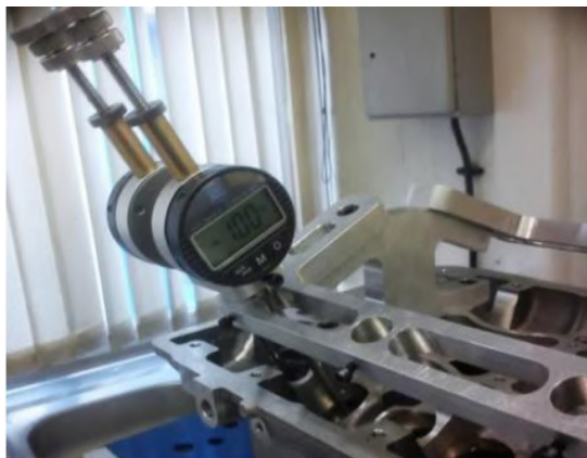
شکل ۵. تنظیم گشودگی سوپاپ با قید مخصوص و ساعت اندازه گیر
