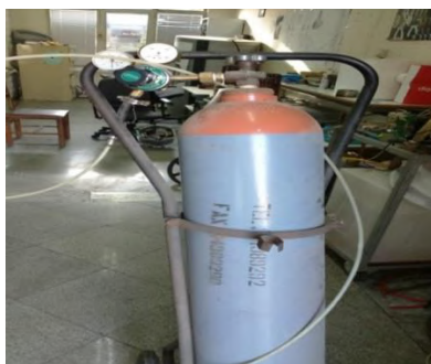
شکل ۱۷. مخزن هلیوم برای فشار منبع سیال عامل
