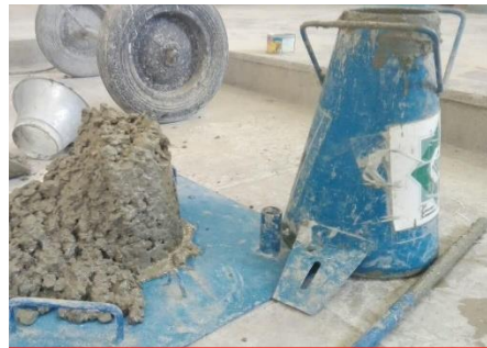
شکل ۴. آزمایش تعیین روانی به روش اسلامپ
