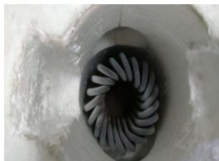
شکل ۱۳. نمایش تولید سرمایش در خروجی موتور استرلینگ گاما با عایق
