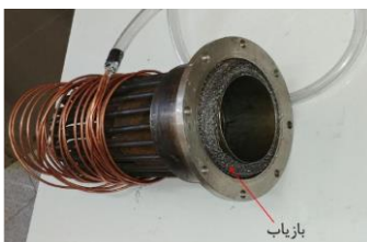
شکل ۷. گرمکن موتور استرلینگ به همراه بازیاب
