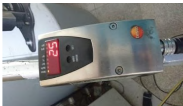
شکل ۱۹. دستگاه (دبی‌سنج) اندازه‌گیری دبی گاز شهری
