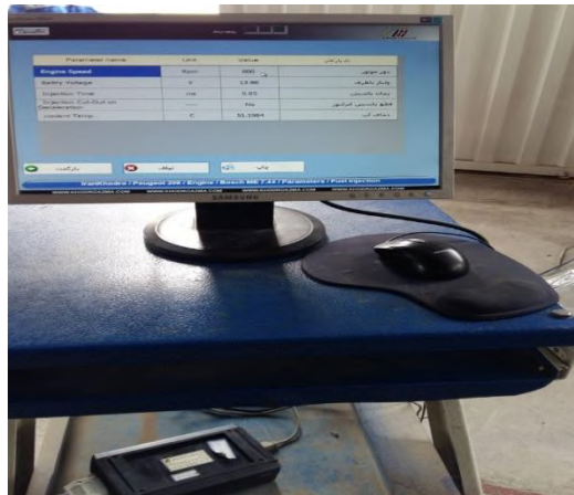
شکل ۲. دستگاه عیب‌یاب خودهای انژکتوری (دیاگ)
