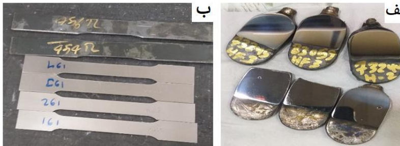
شکل ۳. نمونه‌های آماده شده جهت بررسی‌های ریزساختاری و مکانیکی (الف) نمونه‌های آماده شده برای متالوگرافی (ب) نمونه‌های آماده شده جهت تست کشش.
