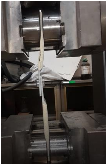
شکل ۱۳. نمایش آسیب دیدگی نمونه سوم در حین انجام تست فشار
