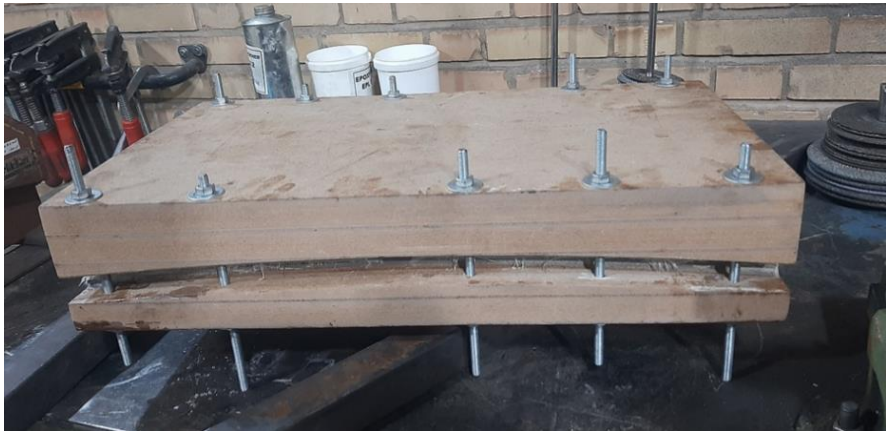
شکل ۳. قالب ساندویچی دو انحنایی در وضعیت بسته شده برای پخت
