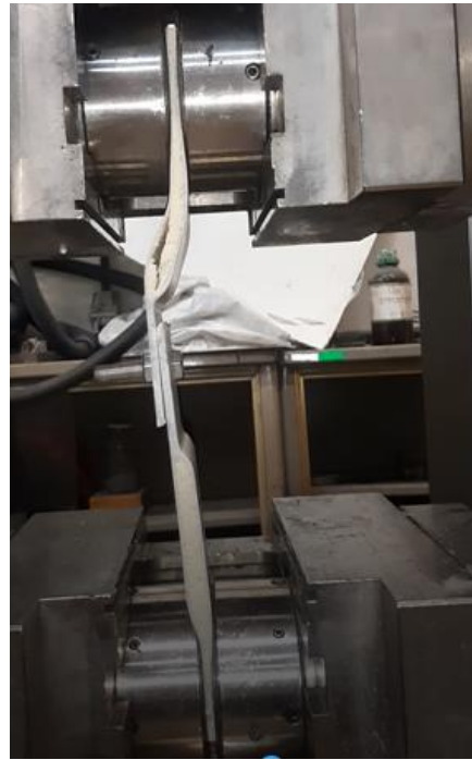
شکل ۱۳. نمایش آسیب دیدگی نمونه سوم در حین انجام تست فشار
