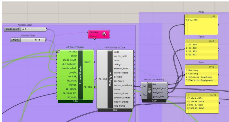
شکل ۱۰. تعیین زاویه‌ی بهینه در سایه بان‌های پروژه‌ی مذکور به منظور کاهش مصرف انرژی. منبع: نگارنده
