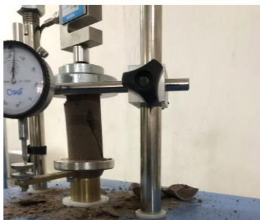
شکل ۵. شکست نمونه تثبیت شده در آزمایش فشاری تک محوری محصور نشده
