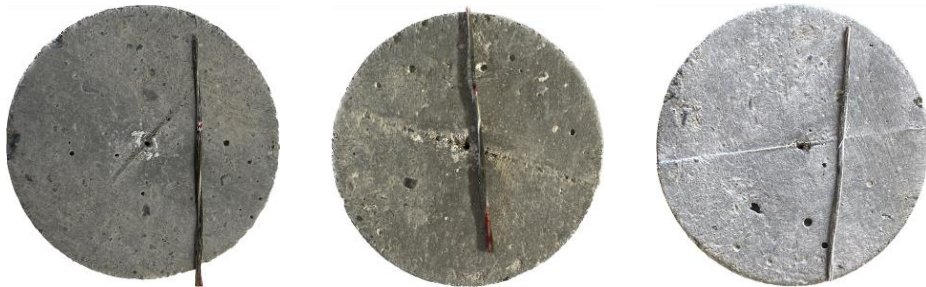
شکل ۱۴. نتایج خروج الیاف از نمونه‌ها در آزمایش بیرون کشیدگی الیاف
