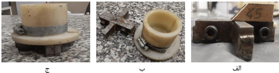
شکل ۹. الف) قرار دادن الیاف با زاویه مناسب در قالب توسط گوه چوبی، ب) گیره نگهدارنده الیاف و قالب و ج) قالب بر روی گیره نگهدارنده
