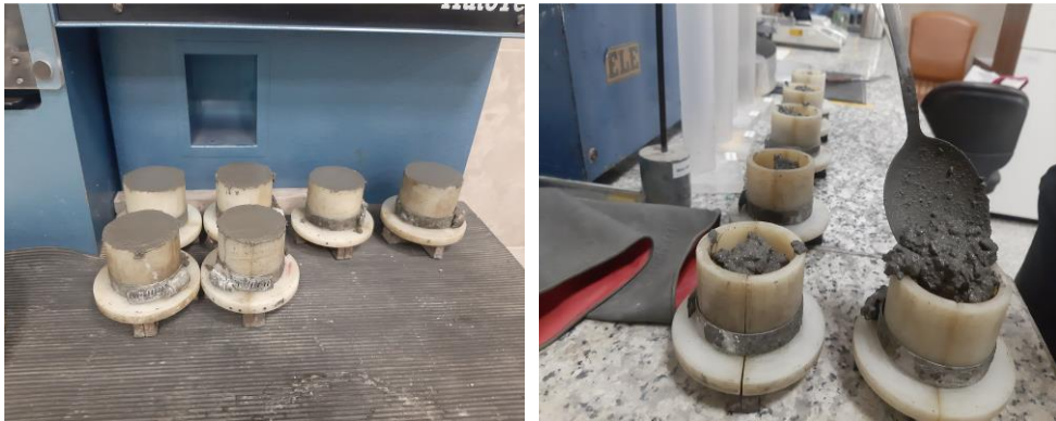
شکل ۱۱. آماده سازی نمونه‌ها برای انجام آزمایش بیرون کشیدگی الیاف از ماتریس بتنی
