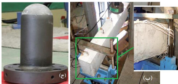
شکل ۳. تست آزمایشگاهی سقوط آزاد چکش بر روی تیر بتن مسلح؛ الف) شماتیک تست، ب) نمای واقعی ج) هندسه چکش با سر نیم کرومی [ ۱۶ ]
