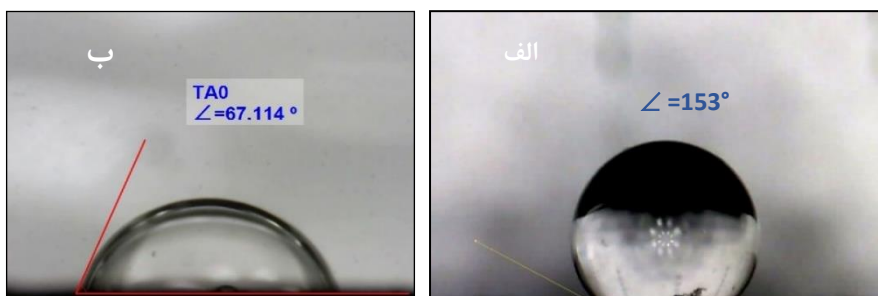
شکل ۲. اندازه‌گیری زاویه تماس [۱]، الف: ذرات پوشش یافته با اسید اولئیک، ب: ذرات مغناطیسی بدون پوشش
