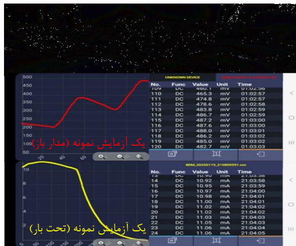
شکل ۱. اطلاعات ولتاژی و جریانی ثبت شده یک ماژول ترموالکتریک نمونه توسط دیتالاگ
