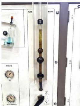
شکل ۵. اندازه‌گیر جریان سوخت لگام ترمز P8160
