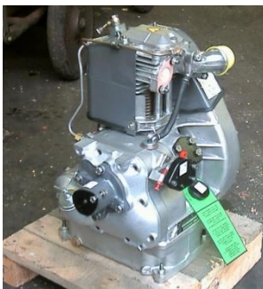
شکل ۱. موتور دیزل لیستر پیتر AC1 Cool
