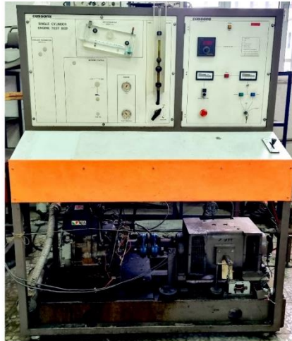
شکل ۲. لگام ترمز P8160 به همراه موتور لیستر پیترا AC1 COOL
