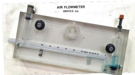
شکل ۶. جریان سنج هوای ورودی موتور لگام ترمز P8160
