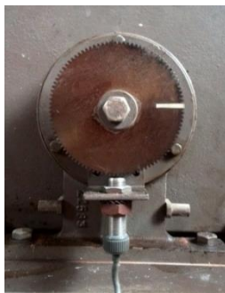
شکل ۴. دورسنج لگام ترمز P8160
