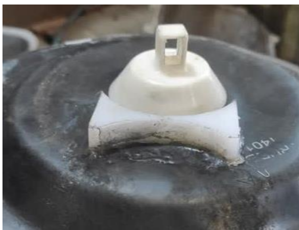
شکل ۱۴. تصویر اجزای داخلی رگلاتور اصلاح شده پس از شش ماه استعمال
