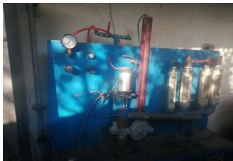
شکل ۱۱. دستگاه تست صحت عملکرد رگلاتور با تغییرات فشار گاز
