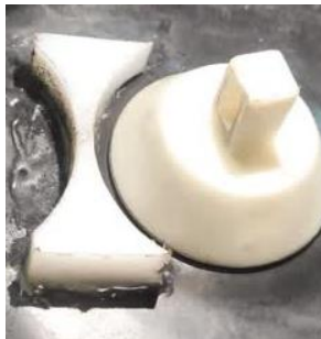
شکل ۱۰. نمونه ساخته شده مانع در مسیر گاز در بخش کم فشار
