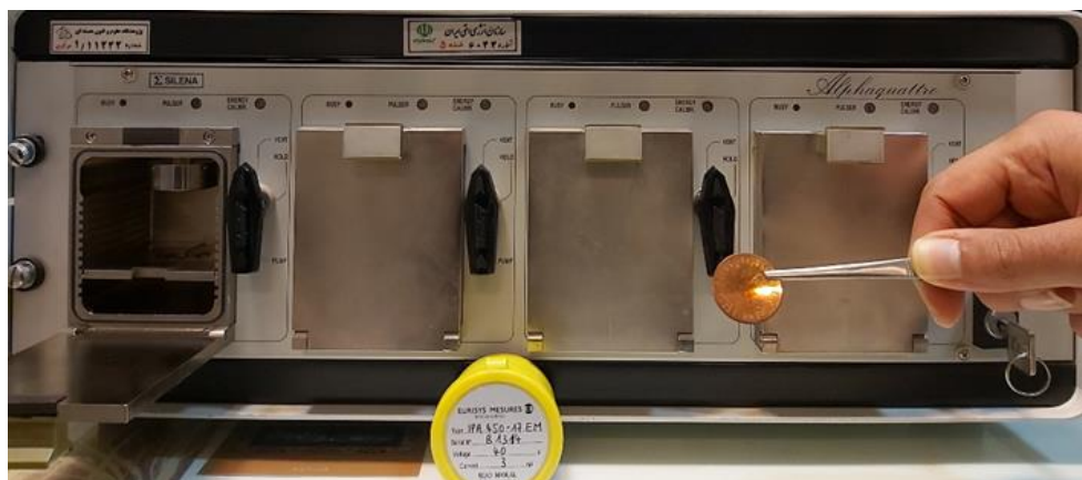
شکل ۱. نمایی از سیستم طیفسنجی آلفا به همراه برخی از تجهیزات اندازه‌گیری.
