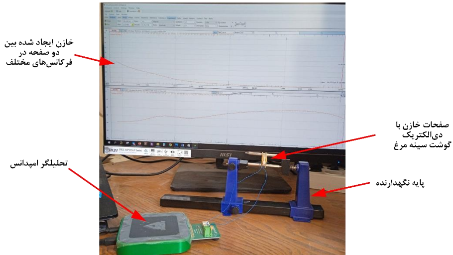
شکل ۸. ساختار پیاده سازی شده برای اندازه‌گیری مقدار خازن تشکیل شده بین صفحات موازی خازن با دی الکتربیک گوشت سینه مرغ
