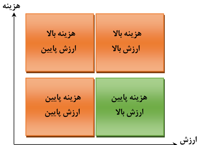
شکل ۱. نمودار مایلز: انواع حالات هزینه-ارزش در یک پروژه ساختمان مسکونی و تعیین گزینه مناسب (مربع سبزرنگ) با روش مهندسی ارزش [۳؛ ۱۶].
