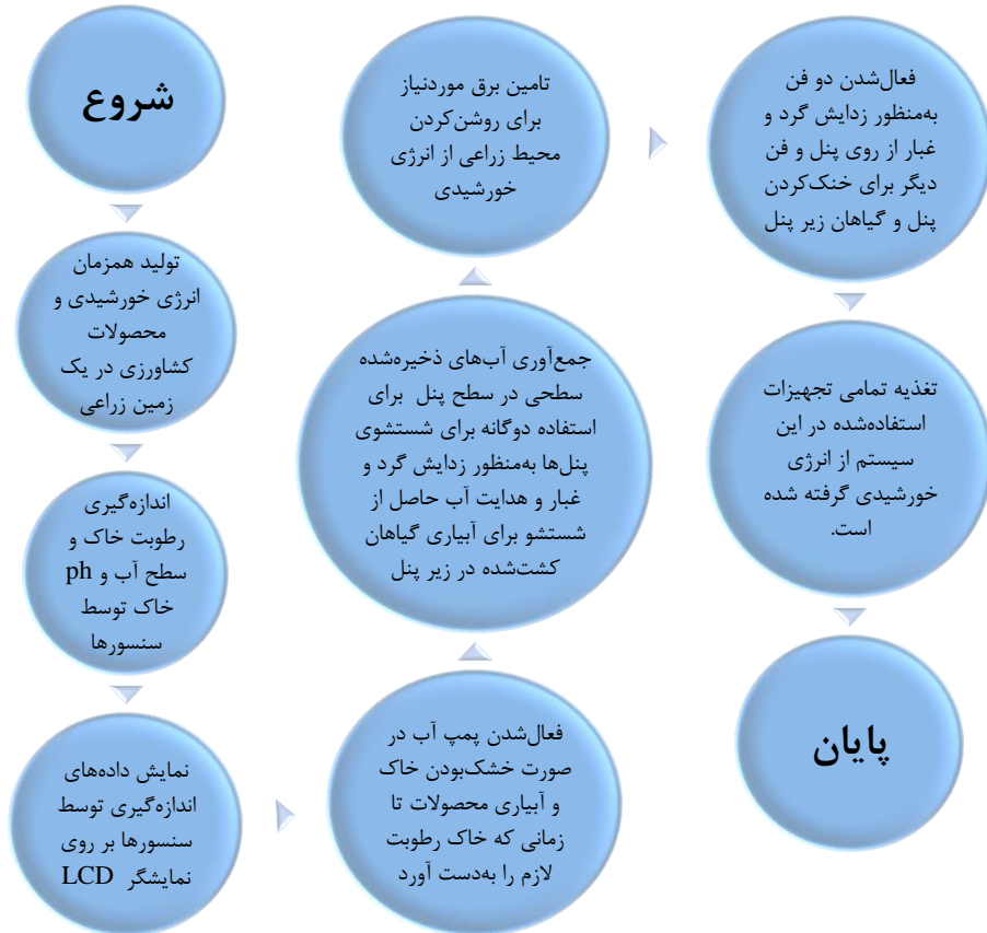
شکل ۶. فلوچارت کلی سیستم.
