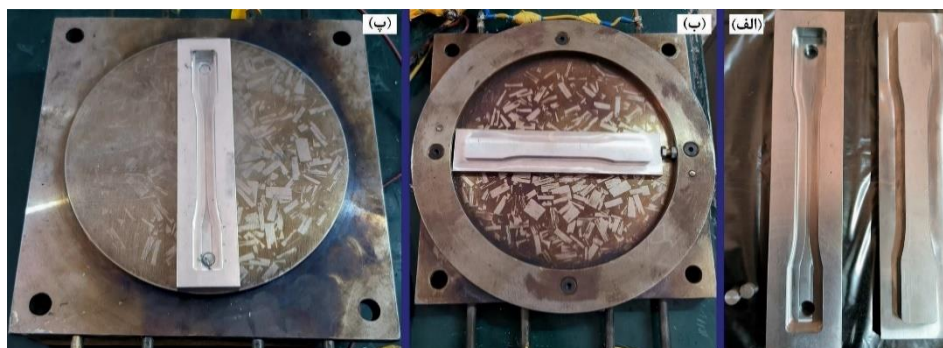
شکل ۲. الف) قالب نمونه‌های آزمون کشش، (ب) قرارگیری ماتریس قالب بر روی صفحه پایینی دستگاه پرس گرم، (پ) قرارگیری سنبه بر روی صفحه بالایی دستگاه پرس گرم.
