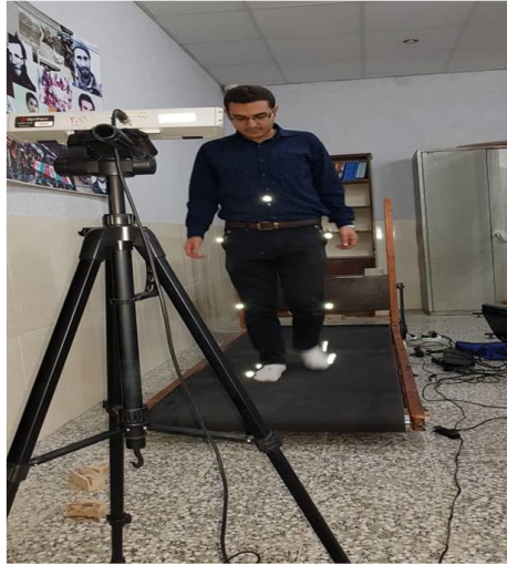
شکل ۲. نقاط روشن، مکان‌های نصب مارکر بر فرد داوطلب برای داده برداری را نشان می‌دهد.
