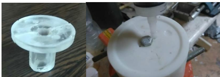
شکل ۶. قالب گیری اتصال توکار کامپوزیتی و نمونه اتصال توکار ساخته شده از رزین اپوکسی ۸۲۸.
