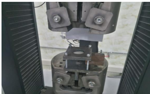
شکل ۸. فیکسچر آزمون نمونه اتصالات توکار و دستگاه آزمون کشش Galdabini.
