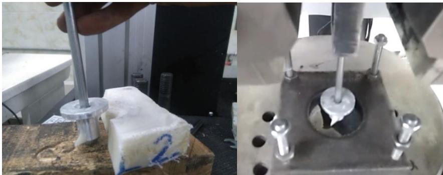
شکل ۱۲. آزمون بیرون کشیدن و موضع آسیب در اتصال توکار.
