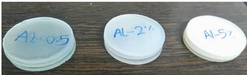
شکل ۹. نمونه‌های استفاده‌شده برای ارزیابی میزان جذب رطوبت ساخته‌شده بر اساس استاندارد ASTM D570 [۱۶]
