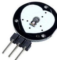
شکل ۴. حسگر اندازه‌گیری تعداد ضربان قلب [۲۲].
