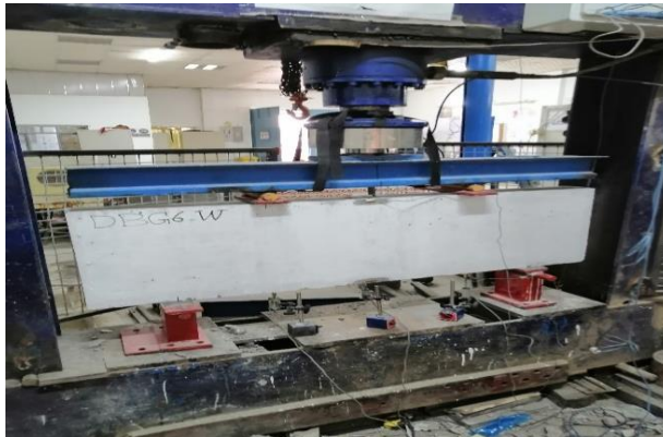
شکل ۸. ستاپ آزمایشگاهی برای تست نمونه‌های آزمایشگاهی تیر عمیق.
