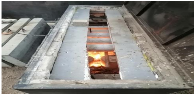
شکل ۳. نمونه‌های استوانه‌ای بتن سبک در کوره.
