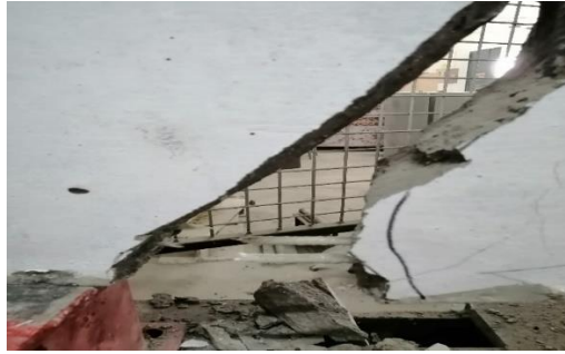
شکل ۱۰. گسیختگی آرماتور GFRP در نمونه DBG15W
