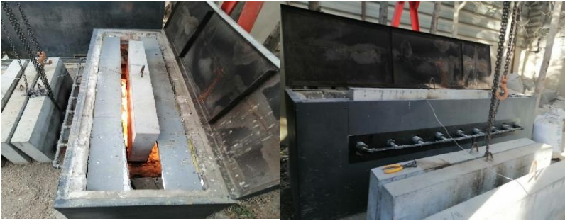
شکل ۶. نمایش کوره و نحوه قرارگیری نمونه‌های آزمایشگاهی تیر عمیق در کوره
