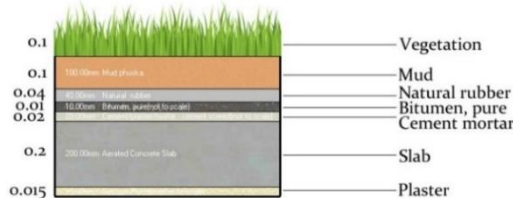
شکل ۵. معرفی لایه‌های بام سبز استفاده شده در تحقیق حاضر [۴۳].
