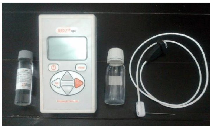
شکل ۲. دستگاه kd2 جهت تعیین ضریب انتقال حرارت نمونه‌ها.
