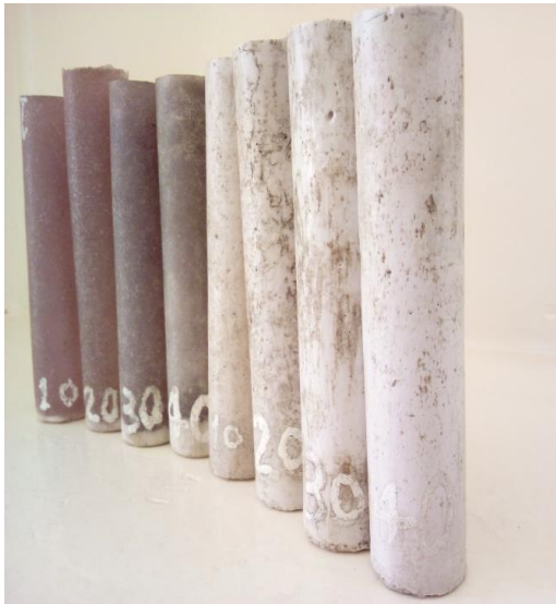
شکل ۴. قالب تحت فشار و نمونه‌های ساخته شده جهت آزمون انتقال حرارت.
