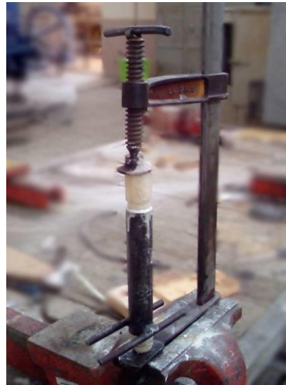
شکل ۴. قالب تحت فشار و نمونه‌های ساخته شده جهت آزمون انتقال حرارت.
