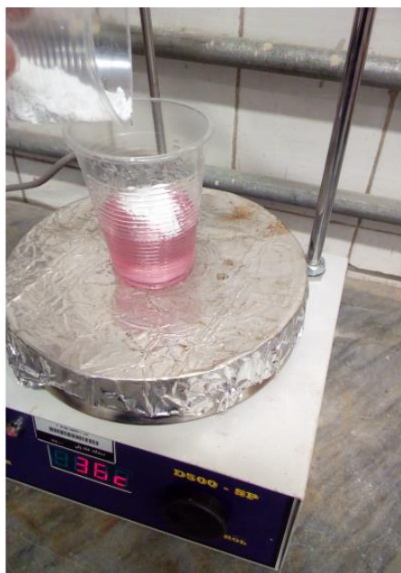
شکل ۱. اضافه کردن مواد افزودنی به رزین قرار گرفته روی همزن مغناطیسی.
