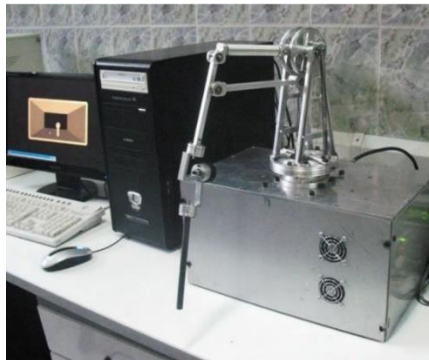
شکل ۲. ربات لامسه‌ای VirSense دارای ۶ درجه آزادی و مکانیزم سری [۱].
