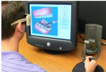
شکل ۱. استفاده از ربات لامسه‌ای برای آموزش جراحی.
