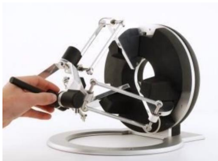
شکل ۳. ربات لامسه‌ای Omega 6 دارای ۶ درجه آزادی و مکانیزم موازی [۱۵].
