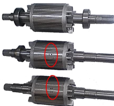
شکل ۸. سه روتور مشابه، روتور سالم (بالا)، روتور با یک میله شکسته (وسط) و دو میله شکسته (پایین).
