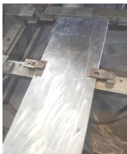
شکل ۴. گیره‌بندی ورق آلومینیومی در دستگاه برش سیم.
