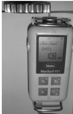
شکل ۱۲. اندازه‌گیری زبری دندانه چرخدنده ساده با دستگاه زبری‌سنج.
