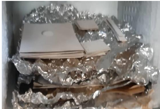
شکل ۲. قراردادن کاغذ کرافت رویه سفید در فریزر برای ۲ و ۴ ماه.
