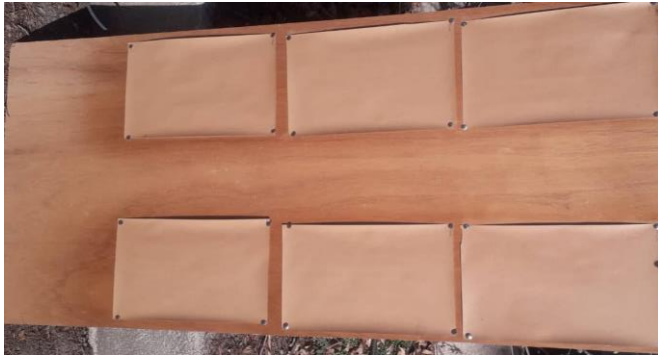
شکل ۱. نحوه مه‌ار و قرار گرفتن کاغذ کرافت رویه سفید برای اعمال پوشش‌دهی اول با پیستوله.
