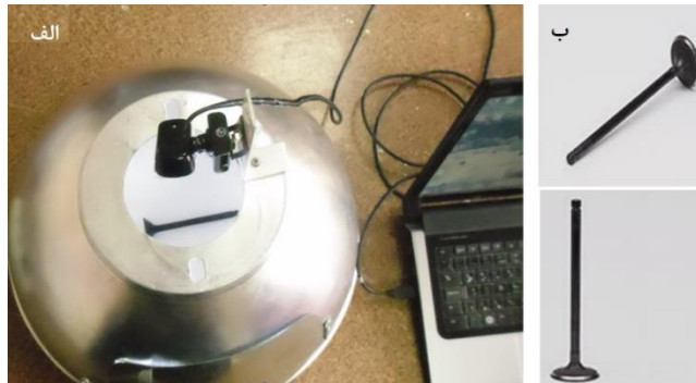
شکل ۲. (الف) محفظه نورپردازی به همراه دوربین، (ب) نمونه ای از سوپاپ مورد آزمون.
