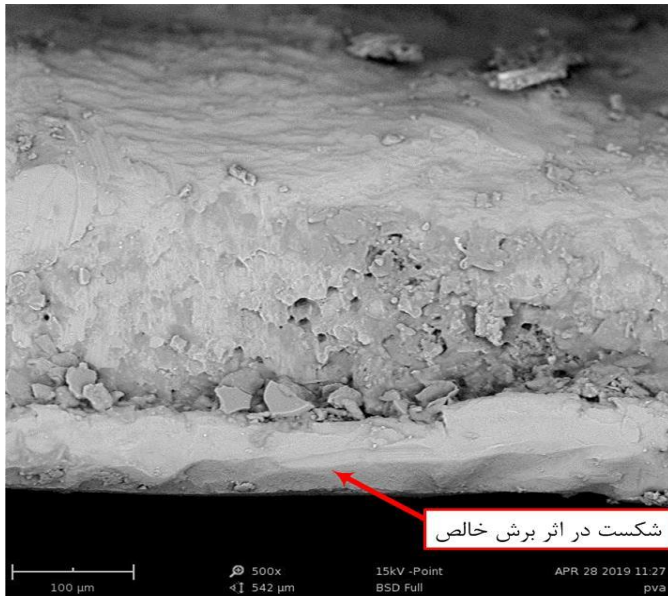
شکل ۱۶. عکس سطح مقطع شکست نمونه در گام شکل دهی، شعاعی ۰/۵ میلی متر و دمای ۱۰۰ درجه سانتیگراد.
