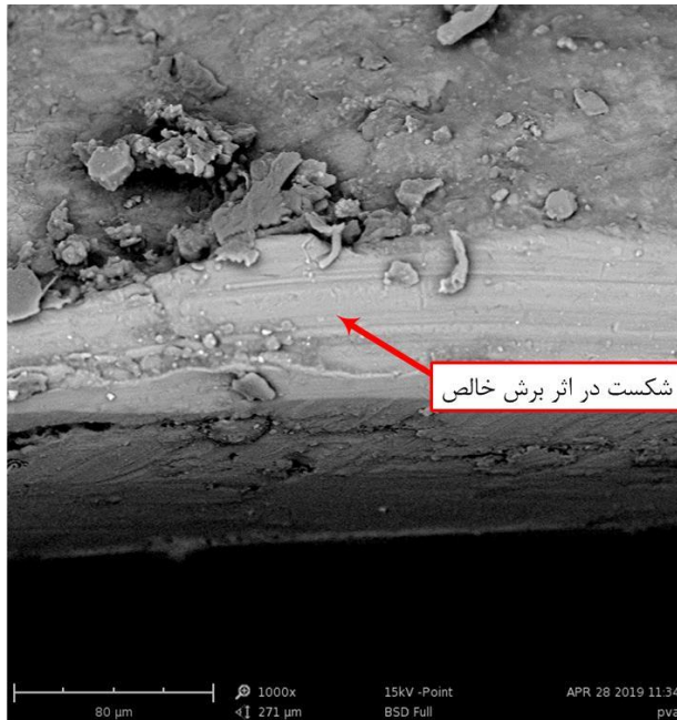
شکل ۱۸. عکس سطح مقطع شکست نمونه در گام شکل دهی، شعاعی ۰/۵ میلی‌متر و دمای ۳۰۰ درجه سانتیگراد.
