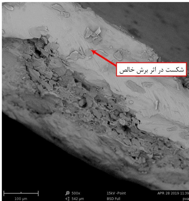
شکل ۱۷. عکس سطح مقطع شکست نمونه در گام شکل دهی، شعاعی ۰/۵ میلی‌متر و دمای ۲۰۰ درجه سانتیگراد.
