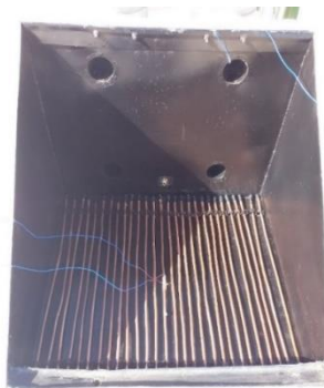
شکل ۳. لوله‌های مسی در حوضچه آب شیرین‌کن.
