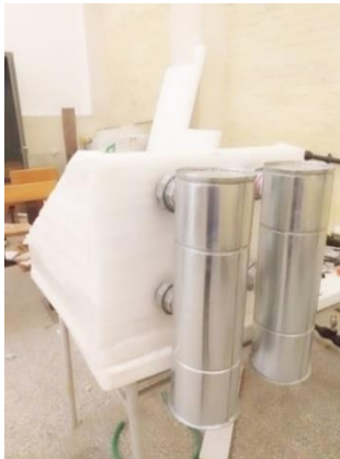
شکل ۴. نصب کندانسور به بدنه آب شیرین کن.
