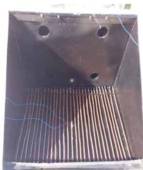
شکل ۳. لوله‌های مسی در حوضچه آب شیرین‌کن.
