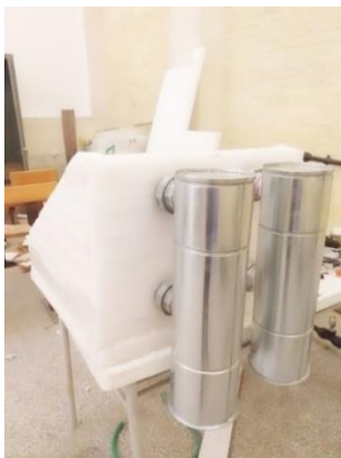
شکل ۴. نصب کندانسور به بدنه آب شیرین کن.
