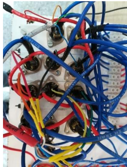
شکل ۱۲. مدار قدرت در بردارنده ۱۲ عدد ترایاک بر روی هیتسینک
