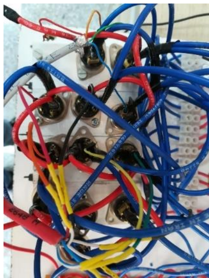
شکل ۱۲. مدار قدرت در بردارنده ۱۲ عدد تراپاک بر روی هیتسینک.
