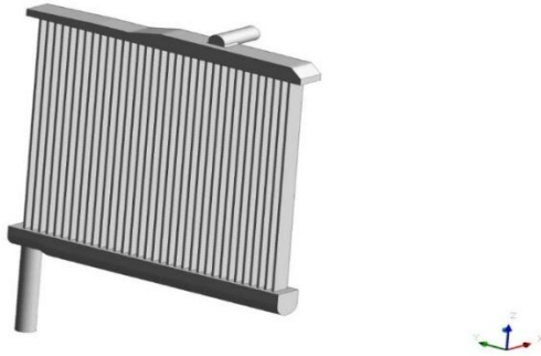
شکل ۵. هندسه رادیاتور توسط نرم‌افزار انسیس
