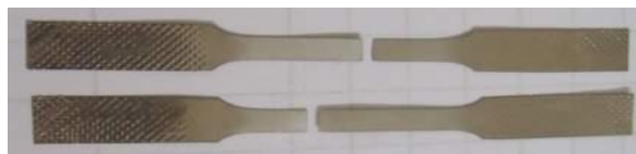
شکل ۴. نمونه‌های آزمون کشش بعد از انجام آزمون
