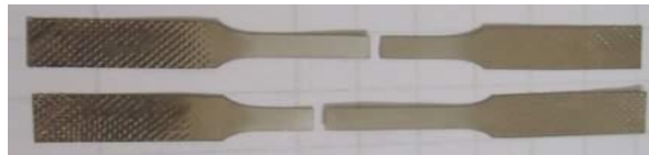
شکل ۴. نمونه‌های آزمون کشش بعد از انجام آزمون.
