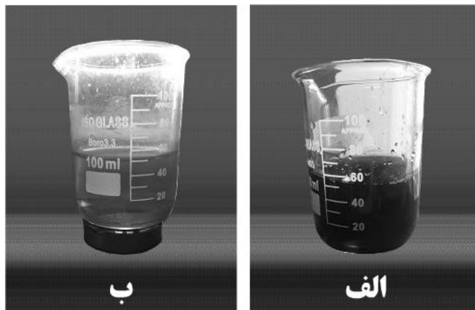
شکل ۲. الف) جاذب در حال جذب (ب) در حال تهنشین شدن روی مگنت
