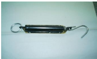
شکل ۲. نیرو سنج جهت اندازه گیری نیروی استاتیکی لازم جهت جداسازی میوه
