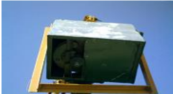
شکل ۱۲. مکانیزم وزنه‌های خارج از مرکز.
