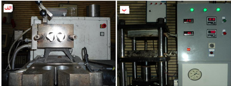
شکل ۱. الف) دستگاه مخلوط کن داخلی، ب) دستگاه پرس داغ.
