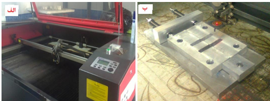
شکل ۲. الف) دستگاه جوش لیزر CO_2 ، ب) فیکسچر مورد استفاده در جوشکاری
