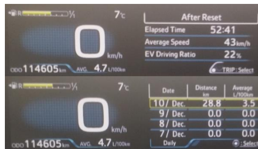
شکل ۳. نمایشگر خودروی تویوتا پریوس هیبرید در انتهای مسیر (رفت) شماره ۱ (تصویر بالا شامل میانگین سرعت و تصویر پایین شامل مسافت طی شده است).
