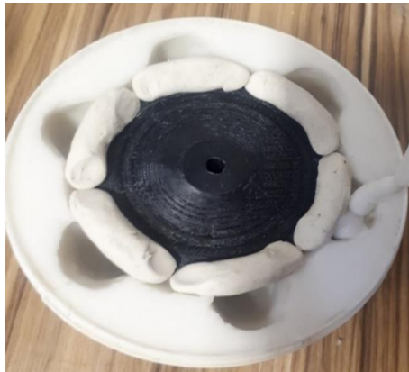
شکل ۴. سفت شدن قسمت اولیه قالب و ریختن سیلیکون درون هر پروانه
