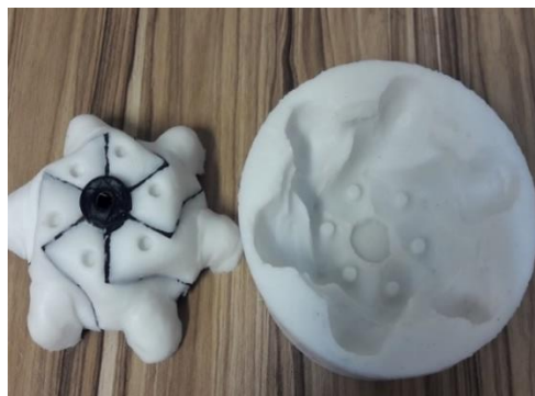
شکل ۳. قالب سیلیکونی RTV ۲ آماده شده برای قالب گیری
