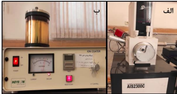
شکل ۴. الف) دستگاه میکروسکوپ الکترونیکی (SEM) ب) دستگاه پوشش‌دهی طلا
