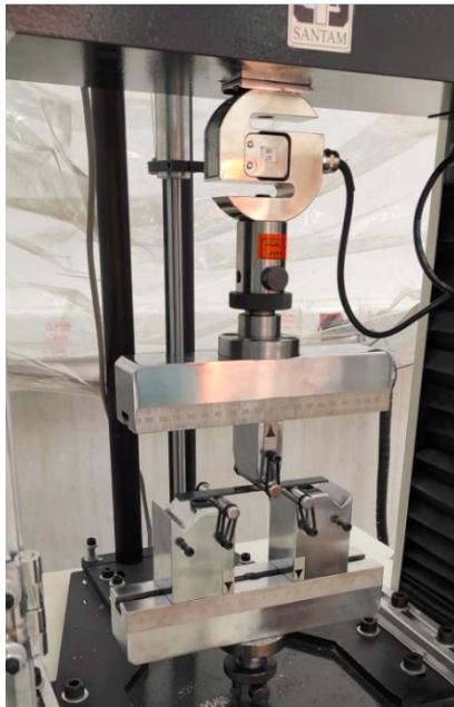
شکل ۳. تجهیزات آزمایشگاهی برای آزمون خمش سه نقطه.
