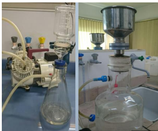
شکل ۳. دستگاه صاف کردن نمونه توسط خلأ در مورد نمونه‌های ورودی (راست) و خروجی (چپ)
