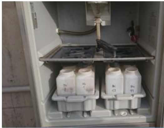
شکل ۲. دستگاه نمونه‌برداری مرکب ۲۴ ساعته
