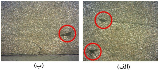
شکل ۹. (الف) و (ب) عیوب WLR و حفره تونلی در نمونه جوشکاری شده با ابزار مربعی. سرعت دورانی ۵۰۰ دور در دقیقه و سرعت پیشروی ۴۰۰ میلی‌متر بر دقیقه.
