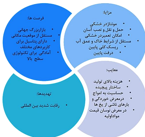
شکل ۶. ویژگی‌های درونی و برونی توربین بادی شناور فراساحلی با فونداسیون نیمه‌غوطه‌ور
