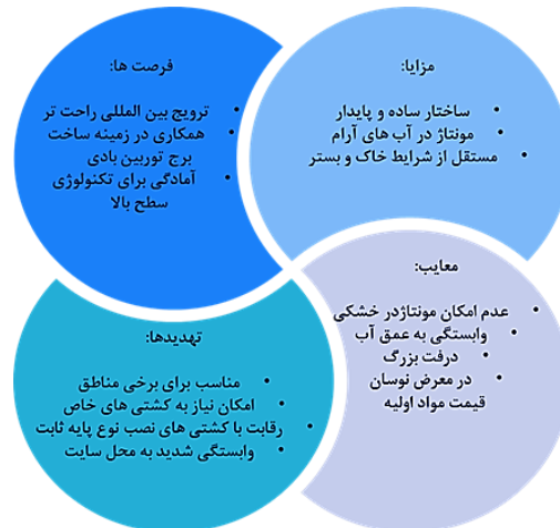
شکل ۱۱. ویژگی‌های درونی و برونی توربین بادی شناور فراساحلی با فوندانسیون اسپار
