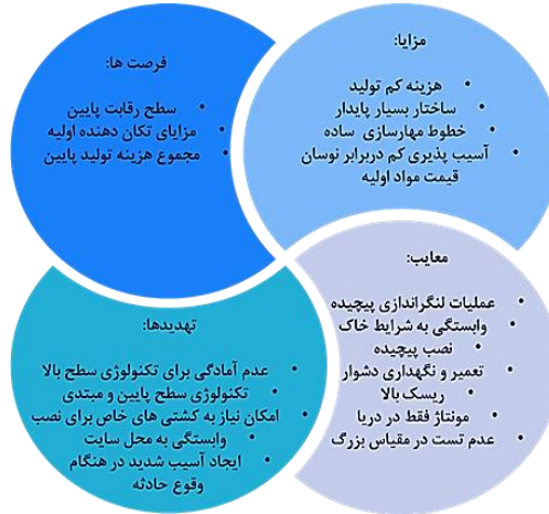
شکل ۱۲. ویژگی‌های درونی و برونی توربین بادی شناور فراساحلی با فونداسیون پایه کششی
