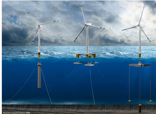
شکل ۱۳. انواع فونداسیون توربین بادی شناور فراساحلی از سمت راست به ترتیب نوع نیمه غوطه‌ور، پایه کششی و اسپار [۶۴]
