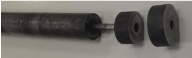
شکل ۱. ابزار جوشکاری با شانه ثابت
