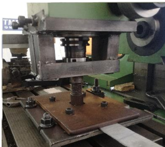
شکل ۳. نحوه بسته شدن گیره و قیدوبند روی دستگاه فرز.
